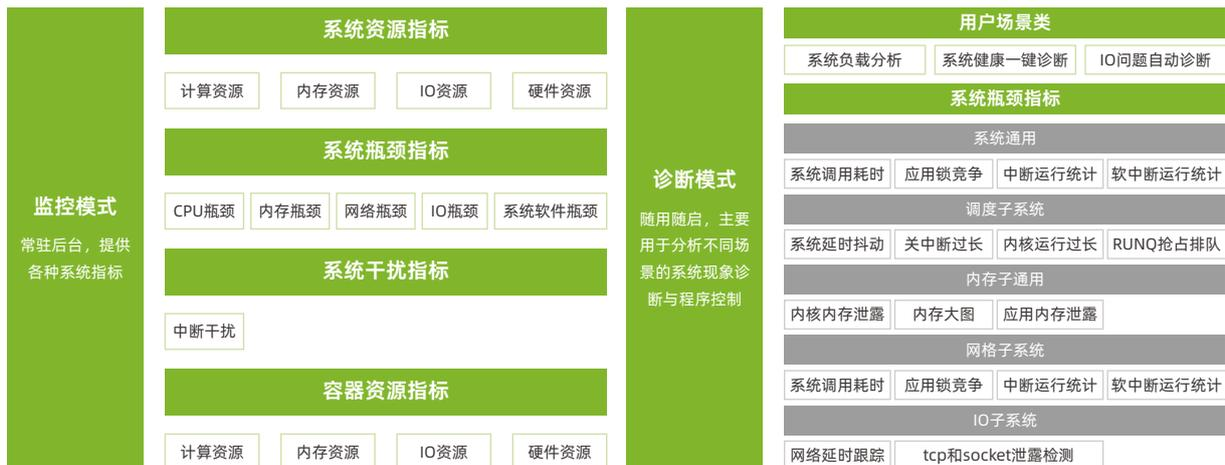
SysAK不仅限于一个工具集, 除了提供系统运维工具本身外, 还设计实现了一套工具开发框架。并通过松散耦合、依赖管理、多架构多版本的构建支持等方式, 保障了工具开发者, 一次开发, 无需额外工作, 就能在主流的架构和操作系统版本上集成。其整体结构如下图所示,
