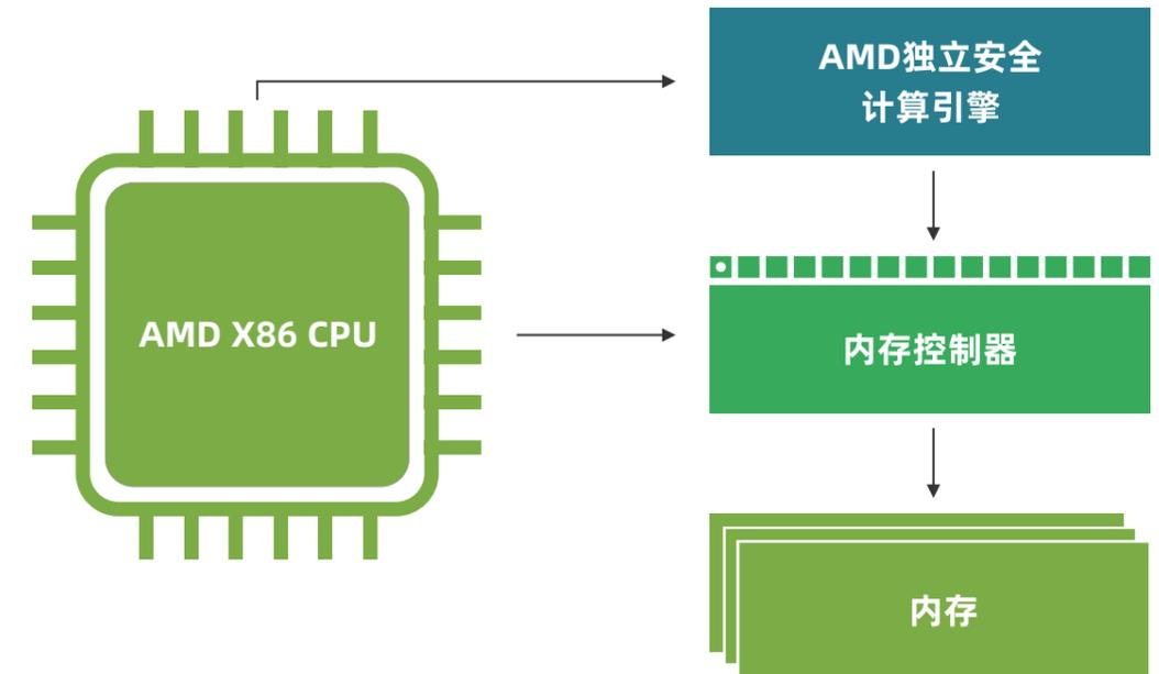
Confidential Virtual Machine也可以称作Secure Virtual Machine (SVM)，是最终实现机密计算的实体，本身作为一个可信域存在，SVM自身和在其中运行的用户程序可以不受来自SVM之外的非可信特权软件和硬件的攻击，从而实现对用户的机密数据和代码的保护。
