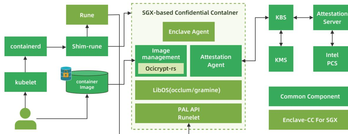
Enclave-cc为云原生用户提供了一种机密容器的部署和运行方案。能够让用户在使用机密容器的时候具有和使用普通容器一样的体感，用户不需要针对于机密容器的场景修改应用，在部署的时候不需要额外的操作步骤。
