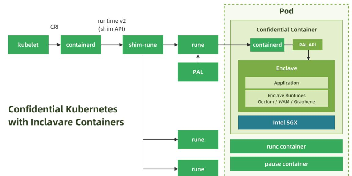
如下图所示，Inclavare Containers 中包含多个组件，这些组件可以利用基于硬件支持的 Enclave 技术使可信应用运行在容器中。包含的组件有 rune、shim-rune、Enclave Runtime等。
