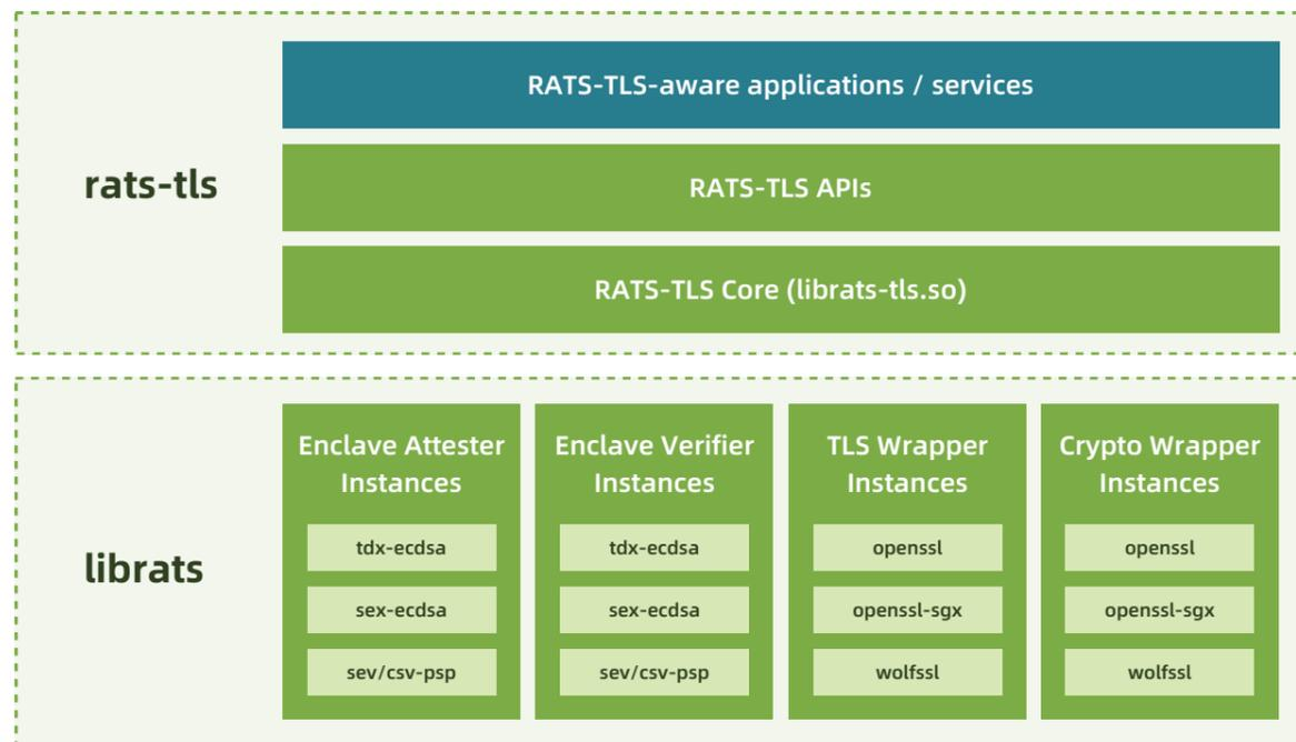
为了提供更好的安全性，核心层与四类实例插件都运行在HW TEE环境中。由于Rats-TLS架构需要支持和灵活选择多种可能性（例如：TLS库，加密库，Enclave形态等），因此根据功能逻辑区分出不同的实例插件是必不可少的。下面简单介绍一下核心层和实例插件的作用。
