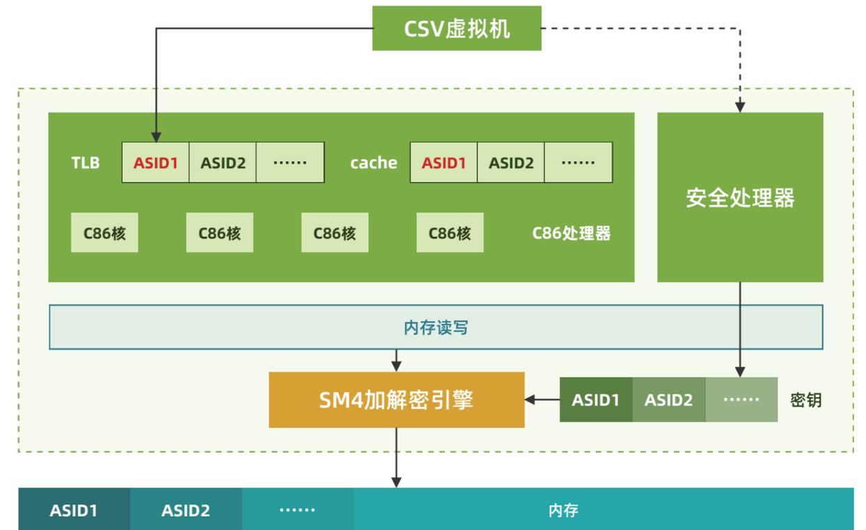
CSV机密容器技术将安全虚拟化技术与Kata容器技术结合，实现容器运行环境的度量 and 加密，容器中的程序可以使用远程认证功能实现身份证明。CSV机密容器和普通容器的接口完全兼容，用户可以使用Docker或者Kubernetes启动机密容器，实现对容器数据的隔离和保护。
